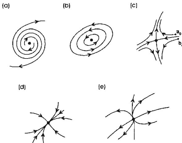
**Рис. 1.6.** Возможное поведение потока вблизи неподвижной точки: (а) неустойчивый фокус, (б) устойчивая эллиптическая точка, (с) седловая точка, (д) устойчивый узел, (е) неустойчивый узел
