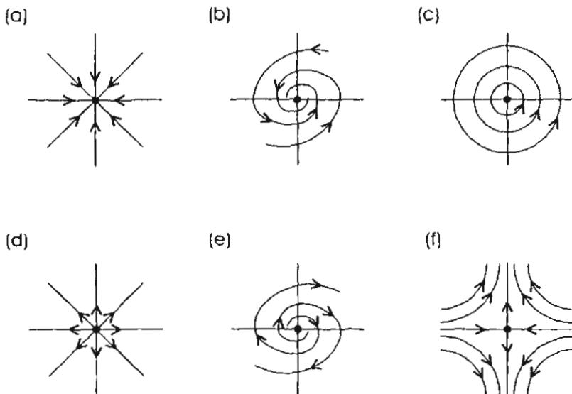
**Рис. 4.7.** Все случаи поведения вблизи точки равновесия двумерной линейной системы: (а) и (б) асимптотически устойчивые случаи; (с) нейтрально устойчивый случай; (д), (е) и (ж) неустойчивые случаи
