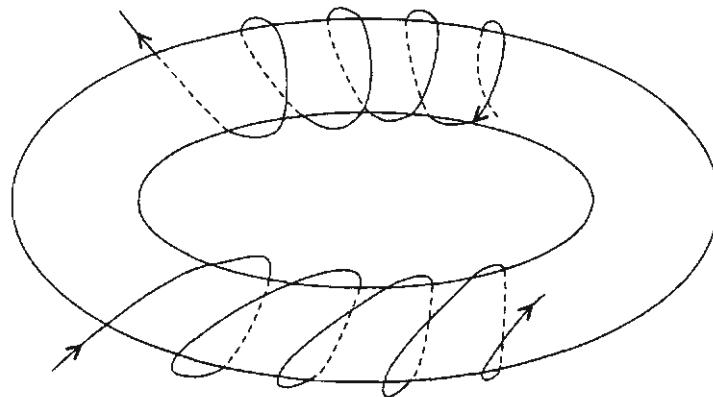
**Рис. 5.9.** Орбита, принадлежащая устойчивому многообразию, и орбита, принадлежащая неустойчивому многообразию тора
