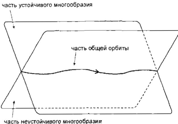
**Рис. 5.10.** Трансверсальное пересечение устойчивого и неустойчивого многообразий тора вдоль общей орбиты
