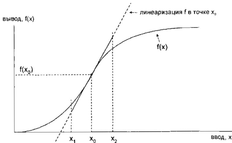
Рис. 4.8. Нелинейная функция и ее линеаризация в точке
