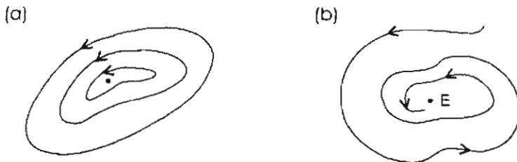
Рис. 4.5. а) Устойчивость в смысле Ляпунова, б) асимптотическая устойчивость для решения, соответствующего положению равновесия
