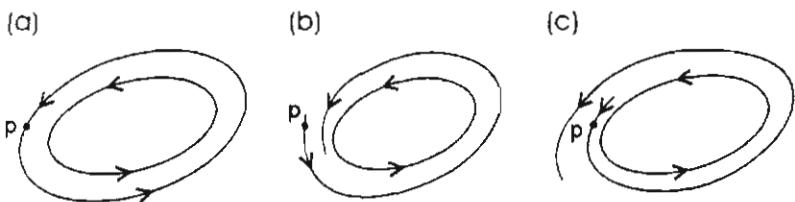
Рис. 1.10. Три возможных типа поведения кривой решения вне периодической орбиты
